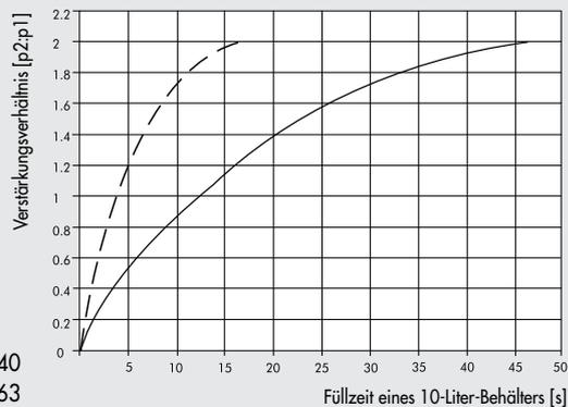
Die Diagramme zeigen die Füllzeiten eines 10-Liter-Behälters mit 8 mm-Schlauchanschluss in Abhängigkeit vom Verhältnis von Ausgangs- zu Eingangsdruck (P2:P1). Die Diagramme gelten für alle Eingangsdrücke zwischen 2 und 10 bar. Die folgende Formel kann für die Berechnung der Zeit t (s) verwendet werden, die erforderlich ist, um in einem Behälter mit dem Volumen V (Liter) von einem beliebigen Druckverhältnis 1 auf ein beliebiges Druckverhältnis 2 zu erhöhen:
