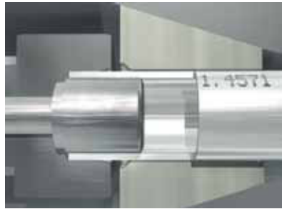
Das Rohr wird bis zum Anschlag in die Werkzeuge eingeführt
